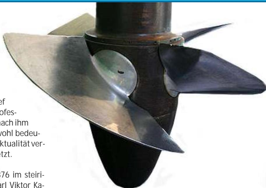
dass sich dieser Turbinentyp bestens für sehr niedrige Fallhöhen eignet. Mit einem bis dahin unerreicht guten Wirkungsgrad von mehr als 90% setzte die Kaplanturbine neue Maßstäbe und ist damit für den Einsatz nicht nur bei großen Flusskraftwerken konkurrenzlos.
