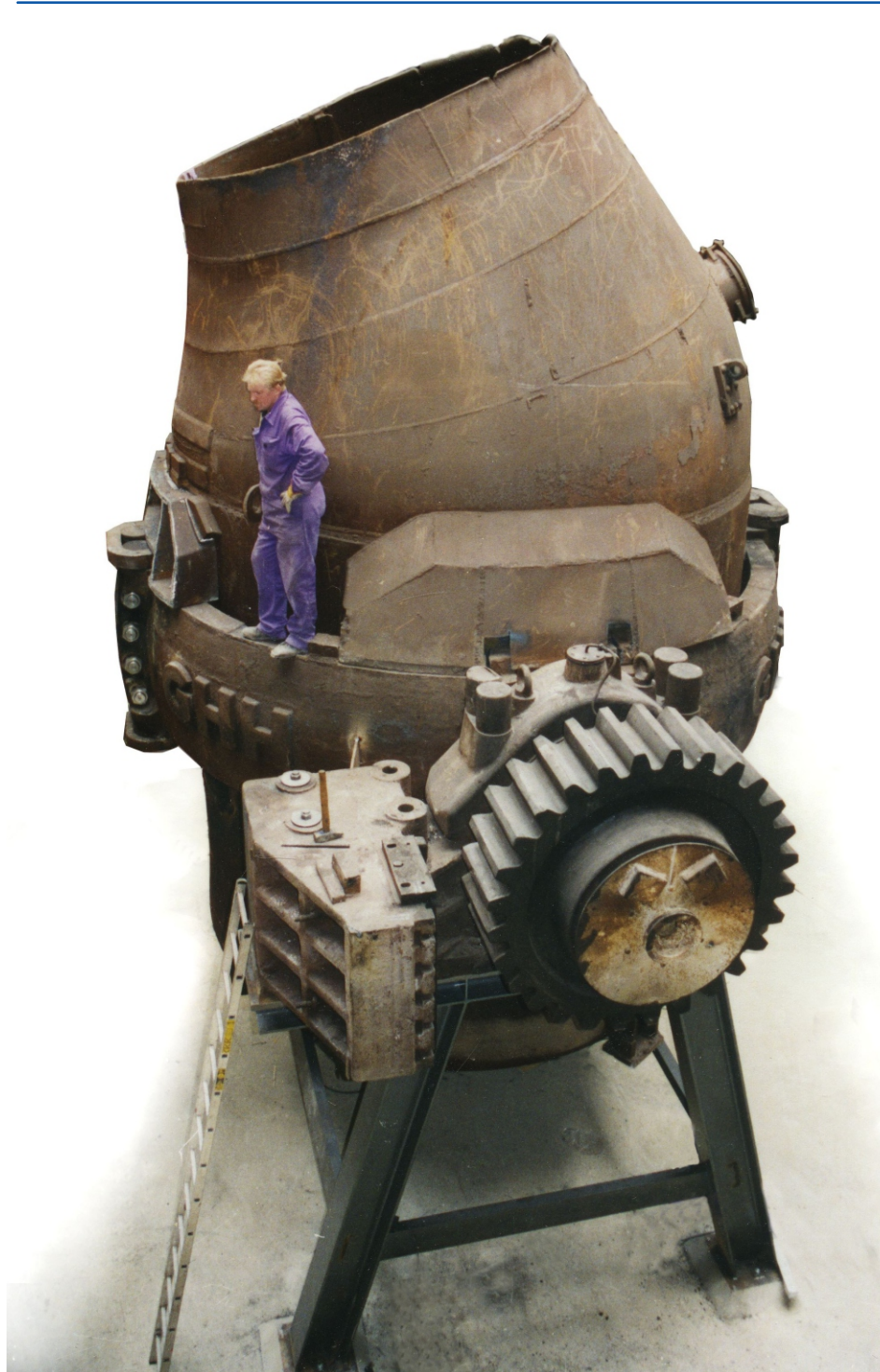
Aufstellung des LD-Tiegels durch VÖEST-Monteure, Oktober 1996 © Technisches Museum Wien
