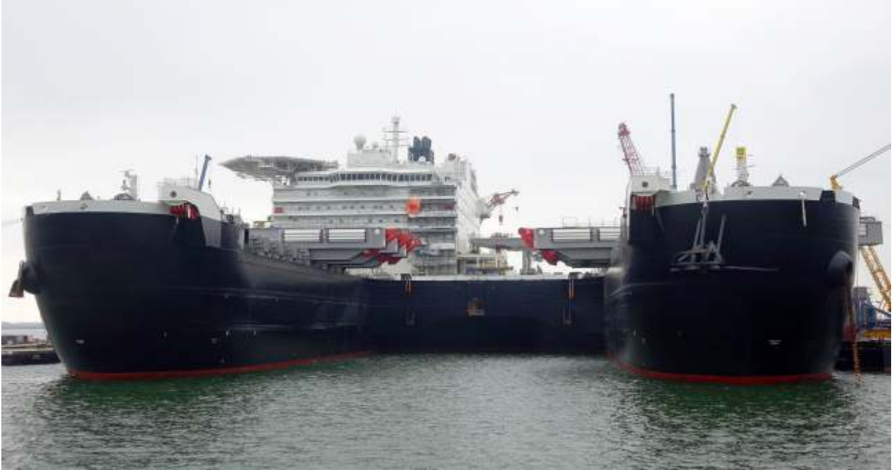
Das größte Arbeitsschiff der Welt: Zwei in Modulbauweise voneinander getrennt hergestellte Schiffsrümpfe wurden katamaranähnlich zusammengebaut, um Offshore-Ölplattformen in die Zange nehmen zu können.
