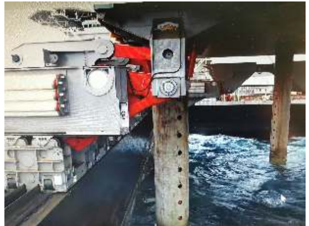
Hydraulische Hubarme, die auf horizontalen Schienen montiert sind, heben bis zu 48.000 Tonnen
